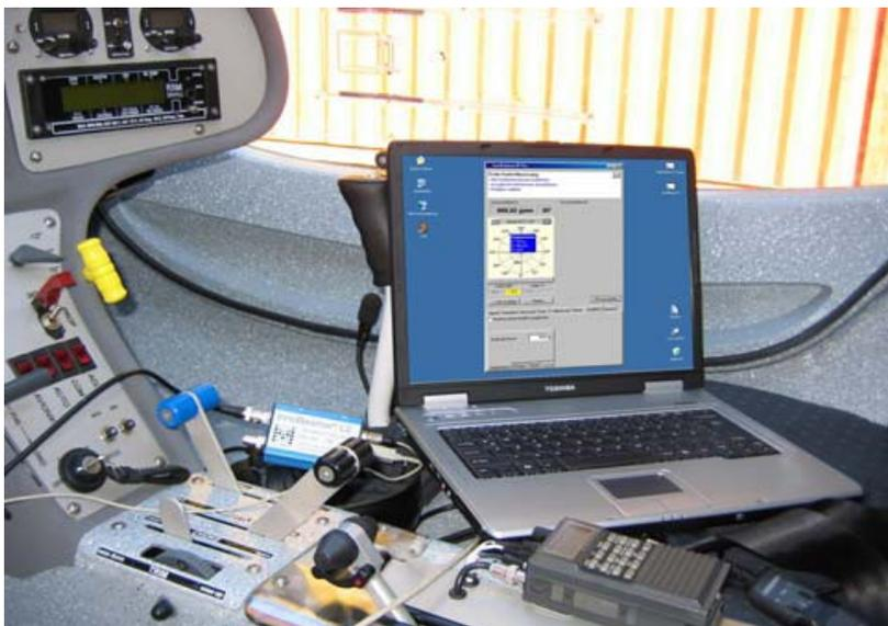
Der Anwender wird von VM-BAL durch den Auswuchtvorgang geführt. Die Software aus dem spürt die Unwucht auf und informiert über notwendige Ausgleichsmaßnahmen. Der Unwuchtausgleich erfolgt angepasst an den Anwendungsfall an vorgegebenen Winkelpositionen des Rotors durch verschiedene Methoden des Hinzufügens oder Entfernens von Masse.
