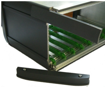
Bild 10: Gehäusedemontage zur Anbringung der Tower-Füße
