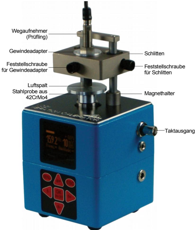
Bild 2: VC21D mit Adapter für Wegaufnehmer und Taktausgang
