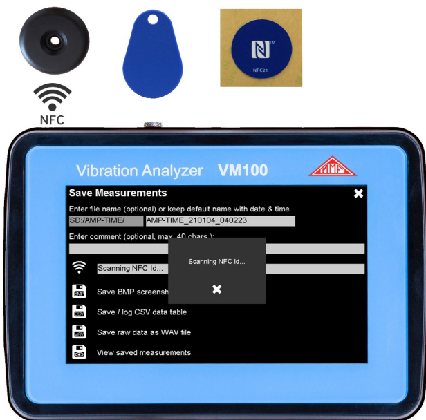
Bild 112: NFC-Erkennung und sensibler Bereich
