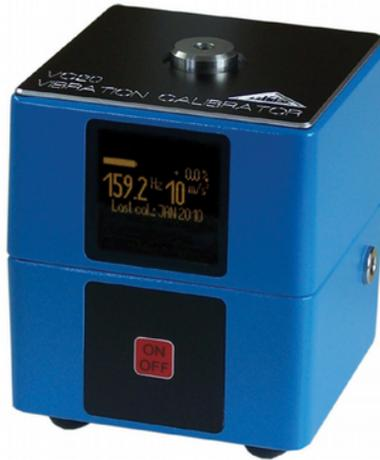
Bild 24: Schwingungskalibrator VC20
