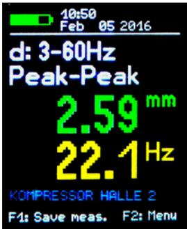
Bild 7: Batterieanzeige (links oben)
