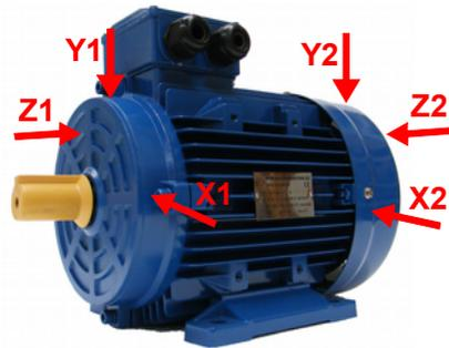
Bild 12: Messorte an Elektromotoren
