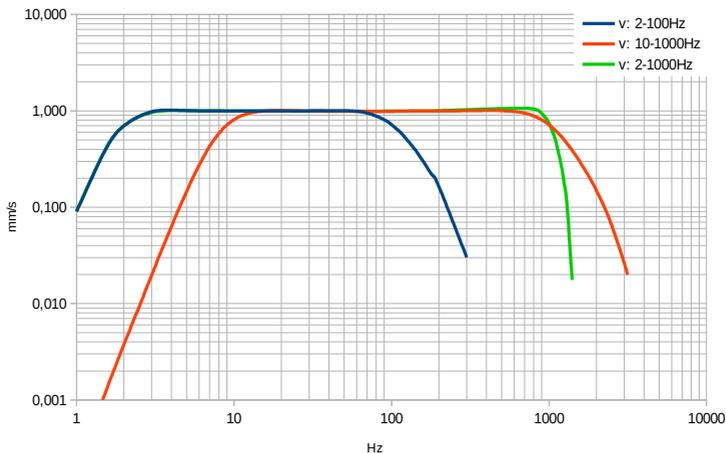
Bild 3: Frequenzgänge des VM23 für Schwinggeschwindigkeit
