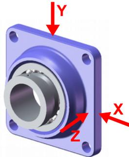
Bild 11: Messorte an Flanschlagern
