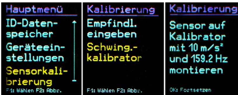
Bild 23: Sensorempfindlichkeit
