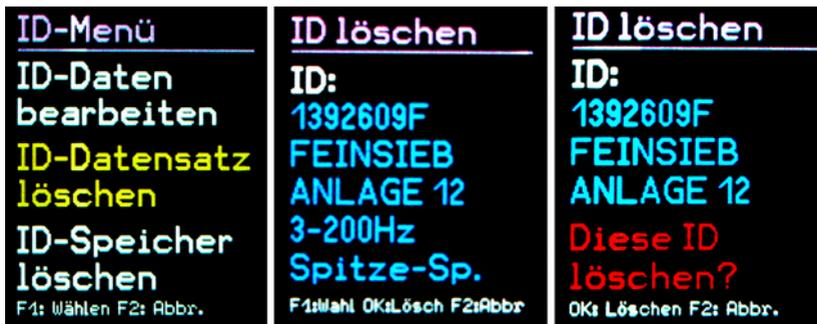
Bild 19: Löschen eines Messpunktdatensatzes
