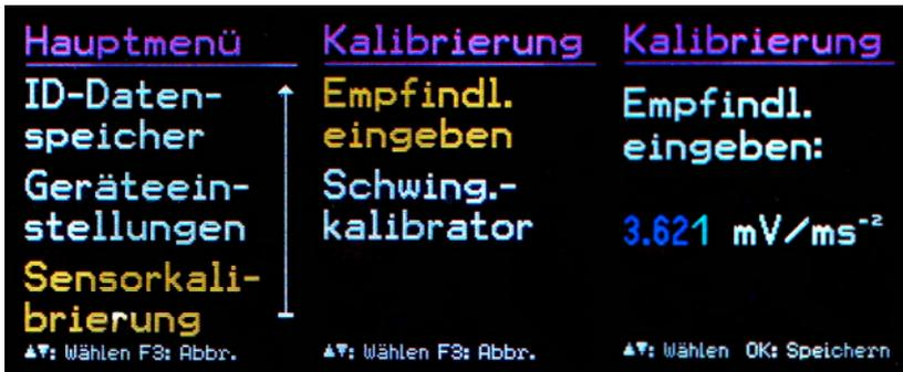
Bild 27: Sensorempfindlichkeit
