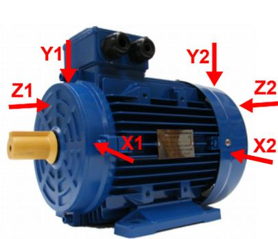
Bild 15: Messorte an Elektromotoren
