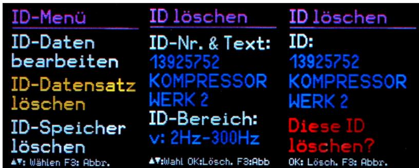
Bild 23: Löschen eines Messpunktdatensatzes
