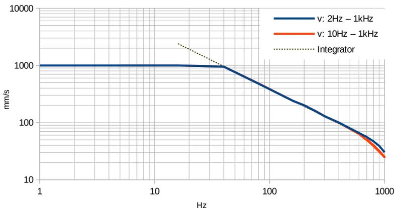
Bild 5: Messbereichsgrenzen für den Effektivwert der Schwinggeschwindigkeit
