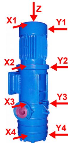
Bild 16: Messorte an Maschinen mit vertikalem Rotor
