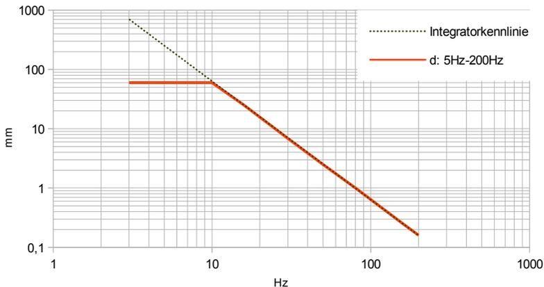
Bild 7: Messbereichsgrenzen für den Effektivwert des Schwingwegs
