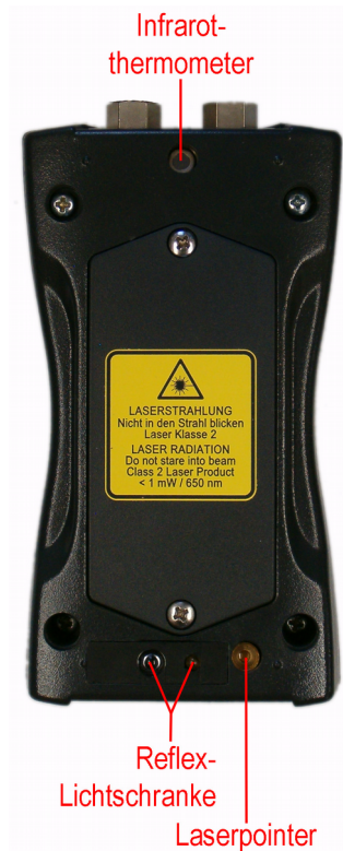
Bild 35: Drehzahl- und Temperaursensor, Laserpointer
