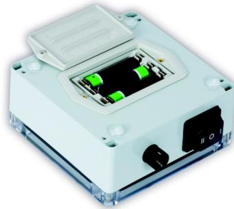
Bild 42: VM40-R2: Batteriefach
