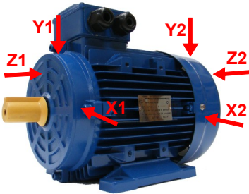
Bild 13: Messorte an Elektromotoren
